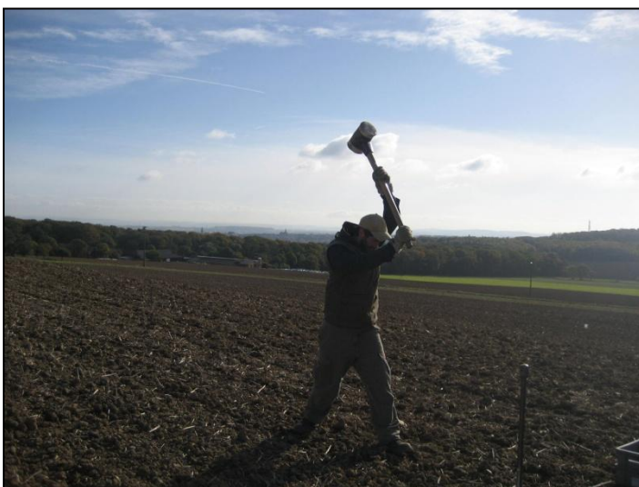
Bild 12" Erkundung der oberflächennahen Bodenzone mittels Bohrstock"
