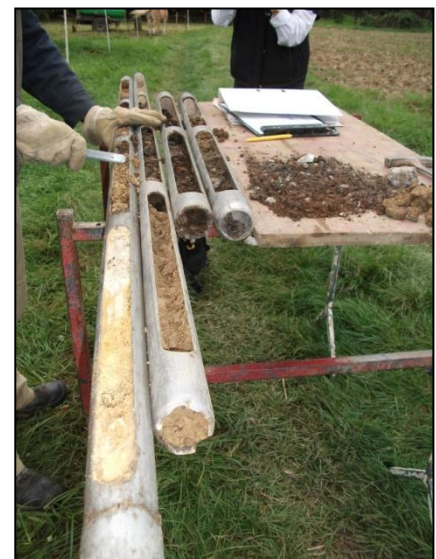
Bild 8" Boden-Probennahme aus den Rammkernsondierungen"
